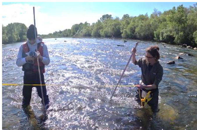
Figure 3 : Mesure des paramètres vitesse, profondeur et granulométrie sur l'Ardèche (20/04/2023)
